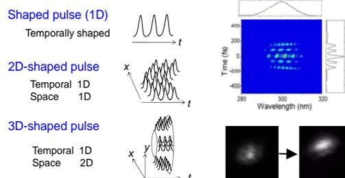
時間波形と空間2次元を制御した超短パルス光の発生とその応用
